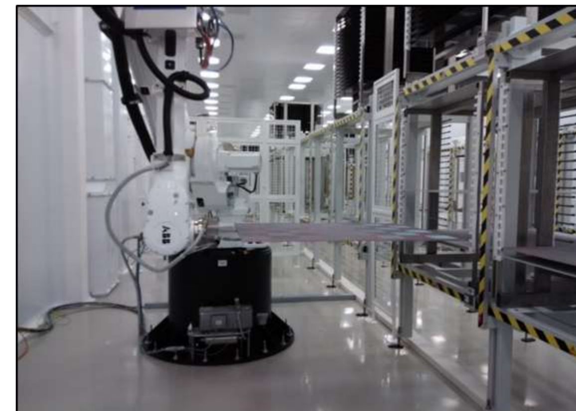
Пробная загрузка паллеты роботом на заводе ООО «Хевел» в реактор плазмо-химического осаждения Si.
